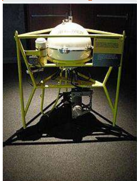
Sismographe Ifremer pouvant être installé de façon temporaire au fond des océans.
