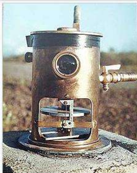
Un tiltmètre au Mauna Loa servant à prévoir les éruptions imminentes mesurant d'infimes changements dans le profil de la montagne.
